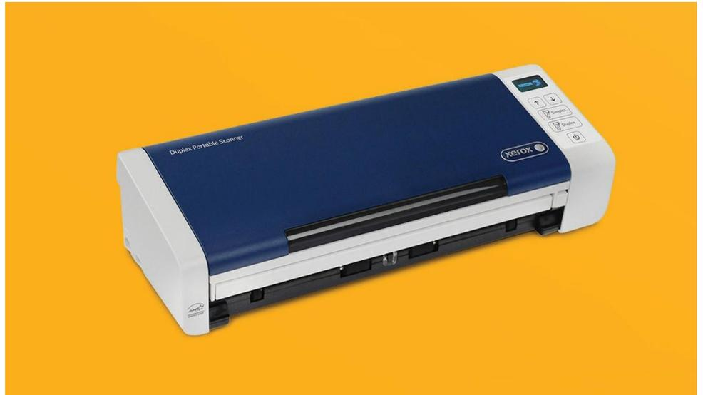
Полностью настраиваемый многостраничный автоподатчик можно установить так, чтобы документ из переднего податчика выходил сзади или спереди. Если вам не нужны лотки сканера, их можно сложить, что удобно для переноски и компактного хранения. Когда лотки раскрыты, Duplex Portable Scanner становится надежным настольным сканером со скоростью до 15 страниц в минуту (30 изображений в минуту) при разрешении 300 точек на дюйм и производительностью 1000 листов в день.
